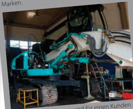
Dieser Kobelco-Bagger wird für einen Kunden am Ausleger umgebaut sowie eine höhenverstellbare und neigbare Kabine für den Abbruch installiert. Die Abbruchhöhe liegt dann bei 20 Metern. Der Bagger erhält dann noch einen EMB Betonpulverisierer.
