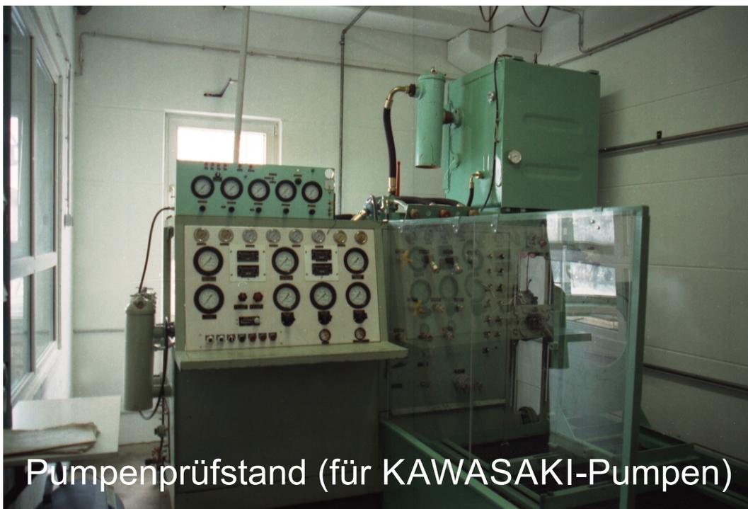
Pumpenprüfstand (für KAWASAKI-Pumpen)
